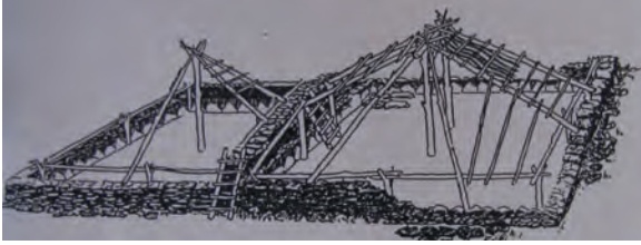
b) Kazakistan, Buguli II yerleşmesinden evin çatı-duvar rekonstrüksiyonu (A. H. Margulan'dan K.M. Baypakov-J.K.Taymagambetov 2006).
